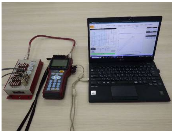
スイッチボックス・データロガー・ ノートパソコンの接続例
